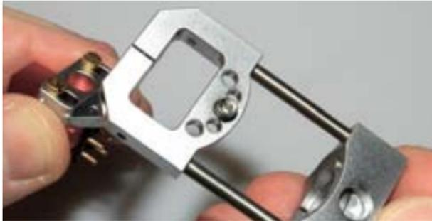
Man merkt, wenn die kleinen Druckfedern die 1 mm V2a Kugel in die Vertiefung an jeder Flanke einrasten lassen.
