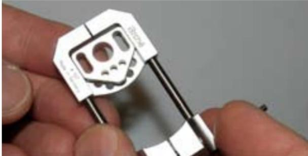
Dieses Gelenk wird dann durch anziehen der M2-Inbusschraube in der Frontspange quasi wieder “ausser Funktion” gesetzt und die Montageplatte auf beiden Flanken fest in die Zange genommen.
